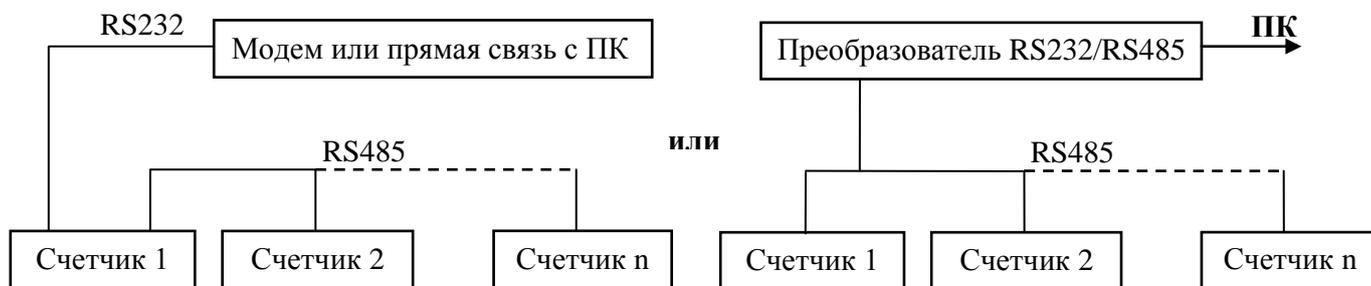
Общая длина линии связи RS485 не должна превышать 2 км. При этом устройства должны быть соединены «цепочкой». На концах соединительного кабеля должны быть установлены терминирующие сопротивления по 120 Ом (распаиваются перемычки между контактами 7 и 8 разъемов). Ниже приведена схема соединительного кабеля RS485 (монтируется пользователем). Монтаж должен быть выполнен витой парой.
