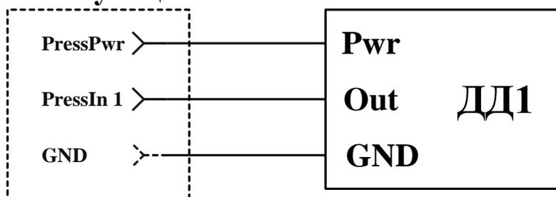
Подключение ДД при использовании внешнего блока питания.
