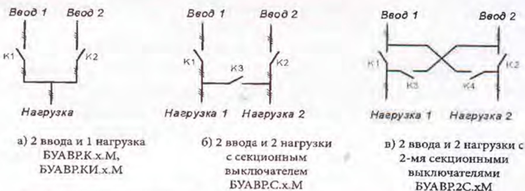
Рис.1. Структурные схемы АВР и модификации предназначенных для них БУАВР
