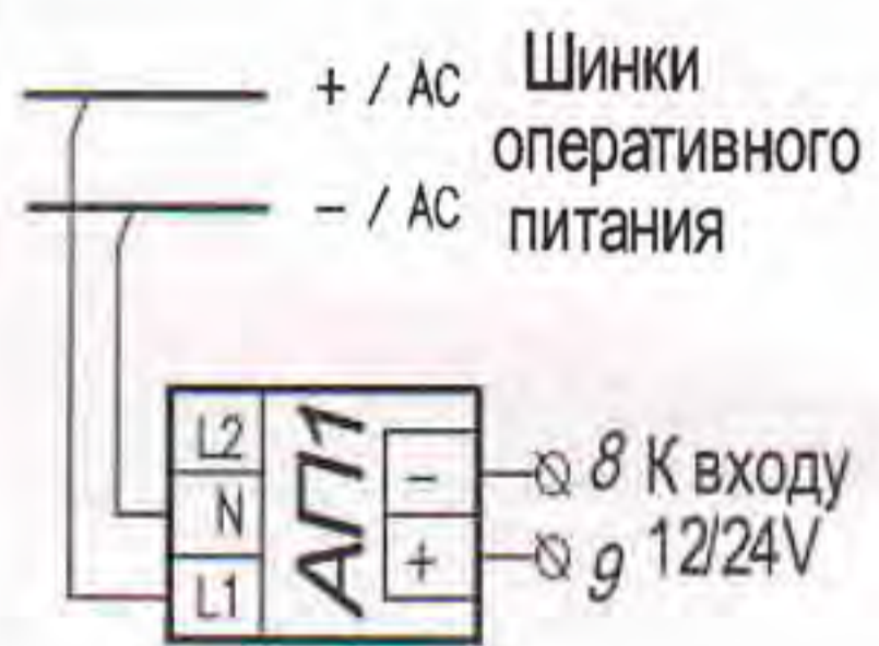
Рис. 7 Схема питания блока БУАВР от изолированного источника оперативного питания
